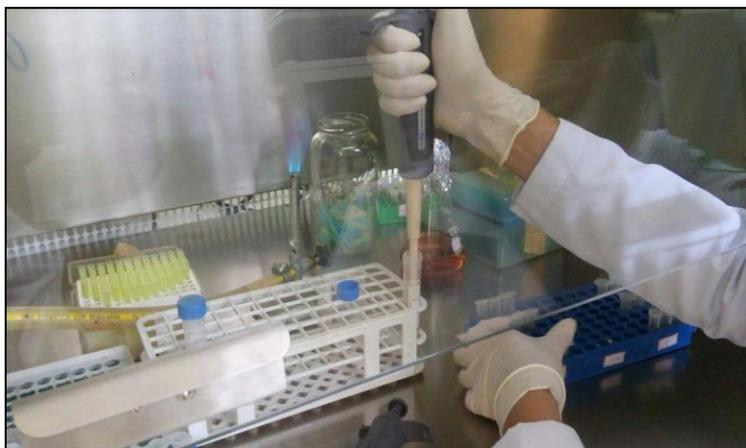
**Figura 33:** Diluição dos produtos para os ensaios antifúngicos (adição de DMSO e água destilada). Fonte: A autora, 2017.
