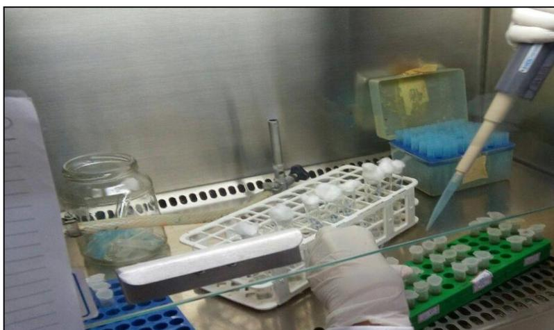
**Figura 34:** Preparação dos Eppendorfs para os ensaios antifúngicos (adição de meio de cultura e inóculo). Fonte: A autora, 2017.
