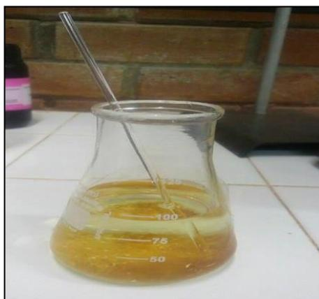
**Figura 7:** Secagem da FAT: Adição de sulfato de sódio anidro. Fonte: A autora, 2017.
