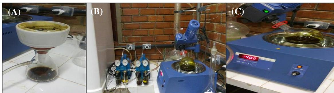
**Figura 3:** Filtração e concentração do EER (extrato de *Erythroxylum revolutum*). (A) Filtragem a vácuo. (B) Rotaevaporação com bombas de pressão reduzida. (C) Rotaevaporador ajustado para 40°C. Fonte: A autora, 2017.
