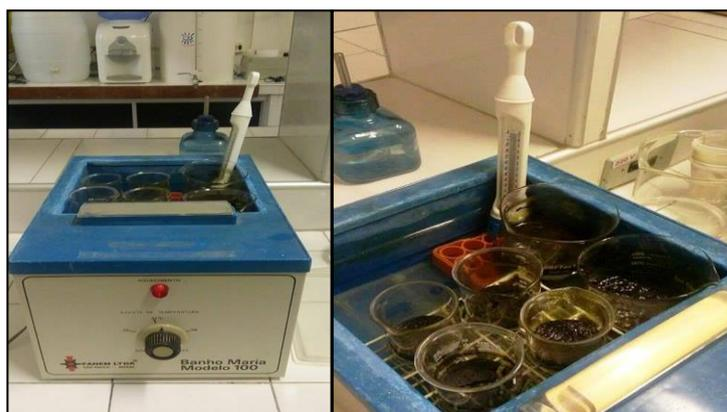
**Figura 4:** Concentração do EER (extrato de *Erythroxylum revolutum*) em banho-maria. (A) Ajuste do banho-maria para 40°C. (B) Monitoramento da temperatura com termômetro de mercúrio. Fonte: A autora, 2017.
