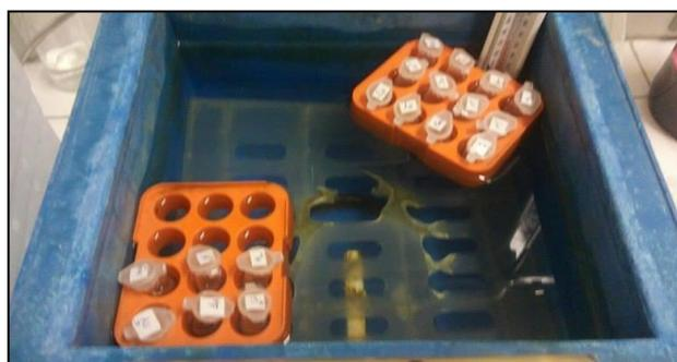
**Figura 19:** Incubação pré-teste das fatias com as soluções-teste em banho-maria a 37°C. Fonte: A autora, 2017.
